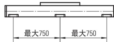
为操纵最大负载，必须至少每隔750mm安装一个安装压块。若所需操纵的负载更小，则相应安装的压块也可减少，请参阅其它技术资料了解更多信息。当总长超过6300mm时直线运动系统由两部分型材拼接而成，须对接合点均进行适当的支撑。
