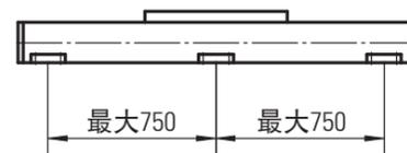
为操纵最大负载，必须至少每隔750mm安装一个安装压块。若所需操纵的负载更小，则相应安装的压块也可减少，请参阅其它技术资料了解更多信息。
